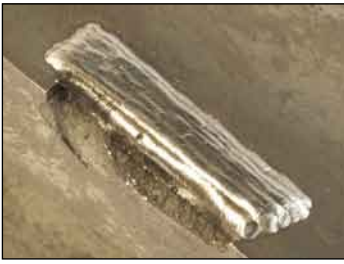
Kantenausbruch (ca. 0,5 cm 3 ) nach Auftragung einiger Schweißnähte
