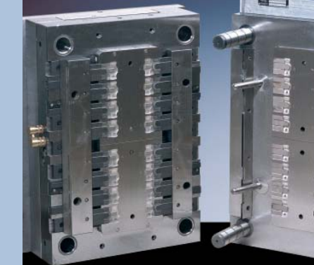
Partikelarme Produktion: BALINIT® C-beschichtete Schieber ermöglichen Trockenlauf
