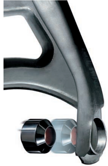
BALINIT®-beschichtete Ziehstempel zur Fertigung von Lochkragen in Radaufhängungen erzielen eine mehr als 10fach längere Standzeit.
